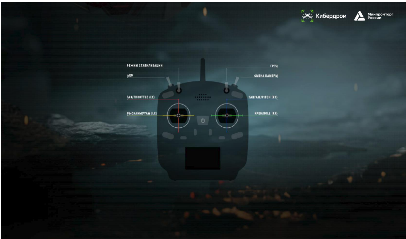
Рисунок 9 – Схема управления БВС в симуляторе с использованием пульта При полете в симуляторе КВАДРОСИМ на экране ПК отображается основная информация, представленная на рисунке 10.
